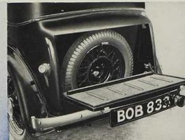
DAS Reserverad ist in einem geschlossenen Raum an der Rückseite des Wagens untergebracht, sodass dieses auch im schmutzigen Zustande das Bild des Wagens nicht beeinträchtigt. Heruntergeklappt bildet die Verschlussklappe die Kofferbrücke.
